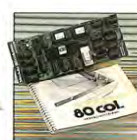
80 colunas: Módulo para mudança do padrão de vídeo para 80 colunas x 24 linhas.
